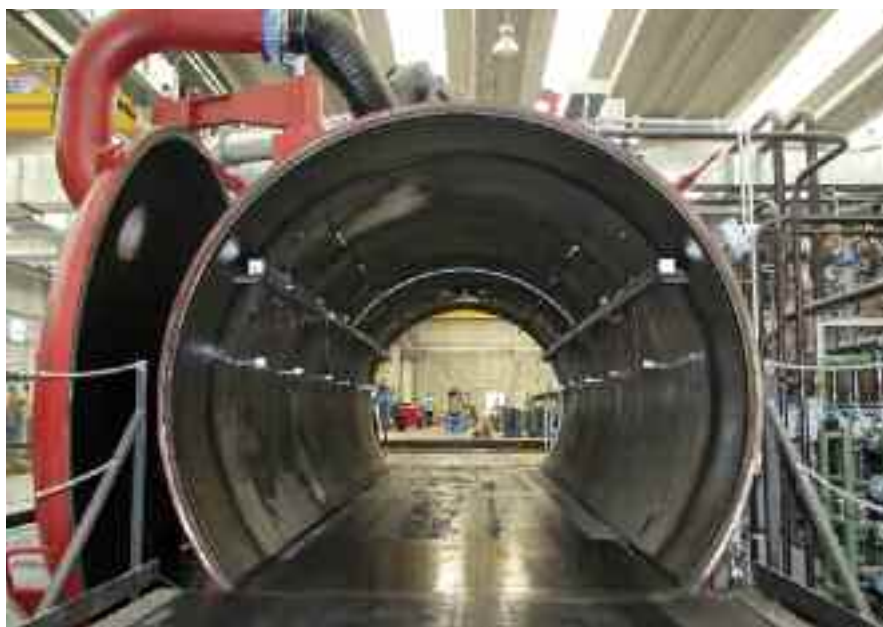
Pignataro - Autoclave per il trattamento di trasformatori
